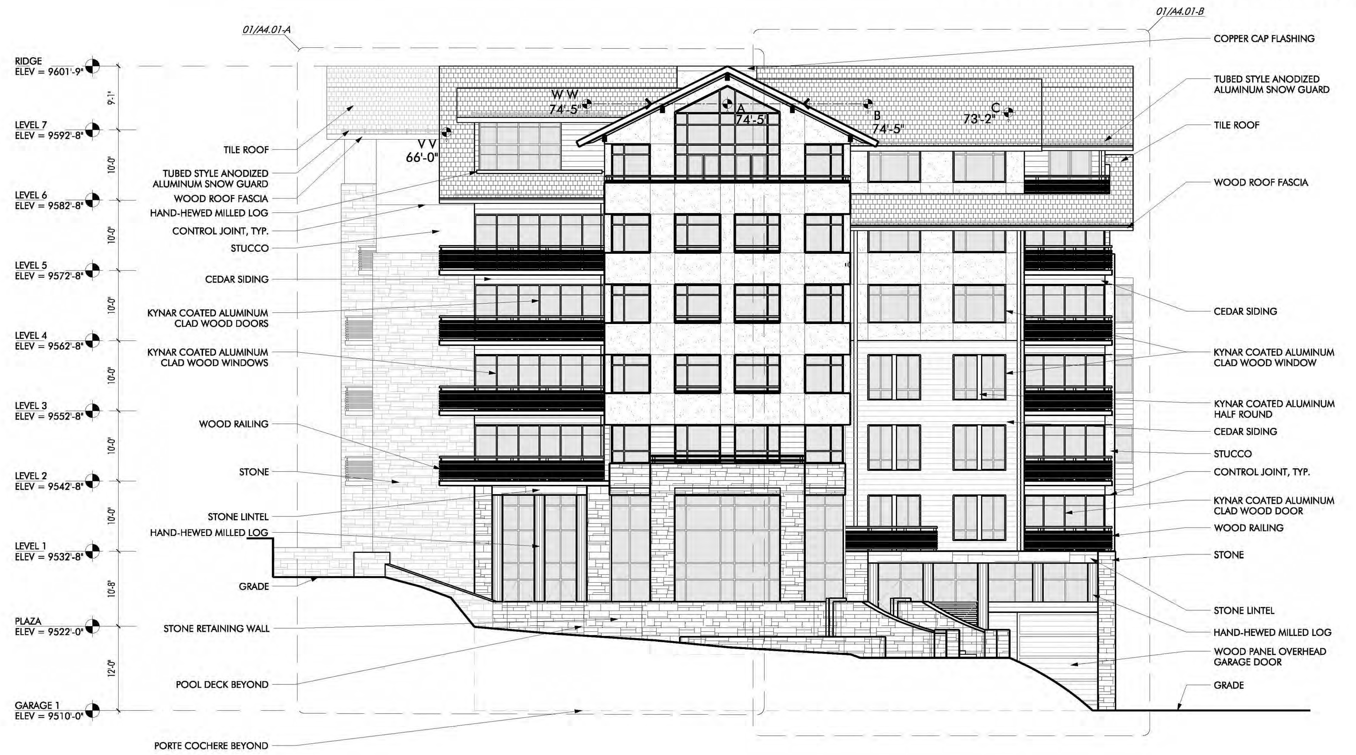
01 WEST ELEVATION SCALE: 1/8" = 1'-0"
