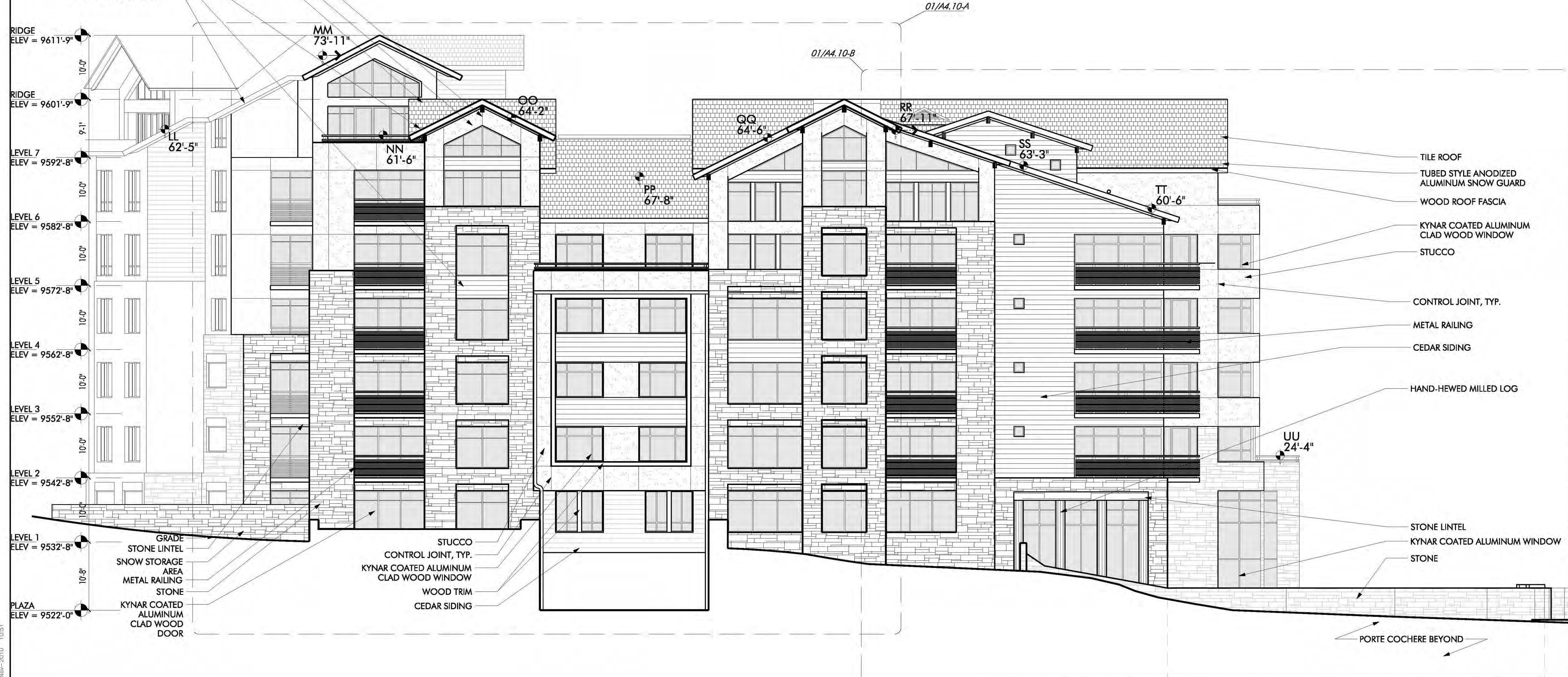
01 NORTH ELEVATION SCALE: 1/8" = 1'-0"
